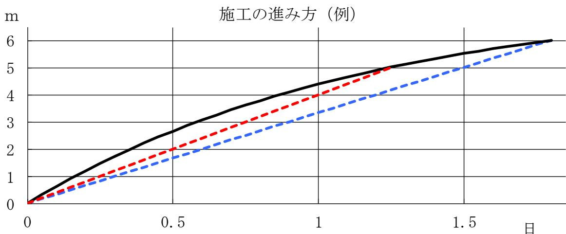
比較表によれば、条件Aの日当たり施工数量は4mで、条件Bは3.36mと算出されているので、それぞれのコアを最後まで施工するには、条件Aで1.25日、条件Bで1.79日かかることになる。
