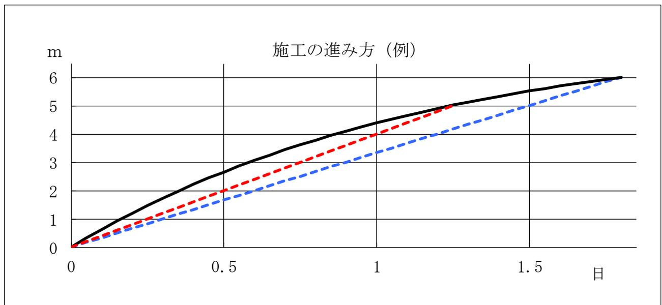
比較表によれば、条件Aの日当たり施工数量は4mで、条件Bは3.36mと算出されているので、それぞれのコアを最後まで施工するには、条件Aで1.25日、条件Bで1.79日かかることになる。
