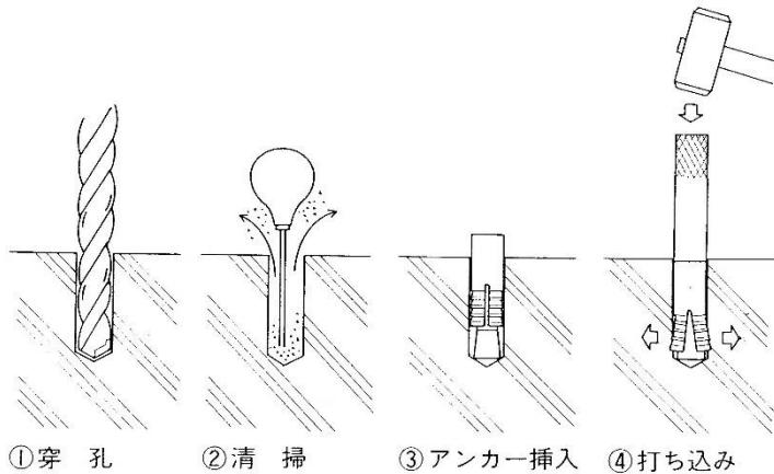
打ち込んだアンカーに寸切りボルトを通して支柱ベースを仮固定する（支柱ベースの固定方法としては、真空吸着方式もあるが、ここでは最も一般的な金属拡張式アンカーによる固定方法を挙げた）。
